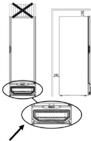
Entrada de aire sin obstrucciones
