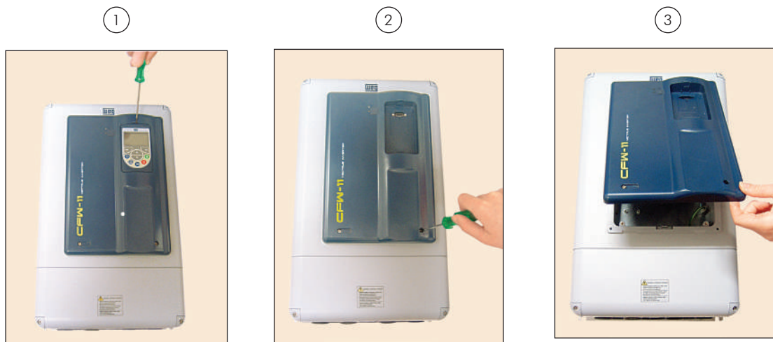
Figura 3.6 - Extracción del HMI y de la tapa del "rack" de control
