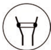
IEC 60947-5-1 Contactos enclavados mecánicamente
