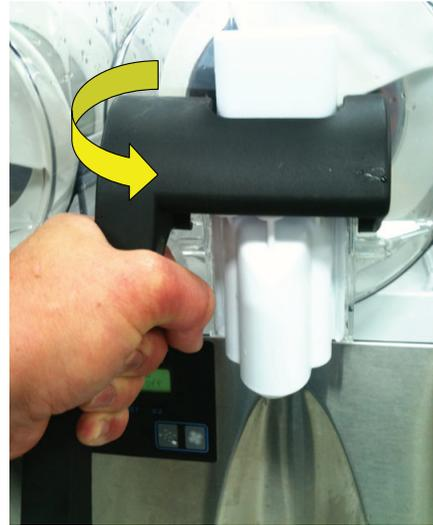
3. Para quitar el mango, tuerza en la misma dirección para liberar el mango del pin del eje izquierdo, luego deslícelo del pin derecho.
